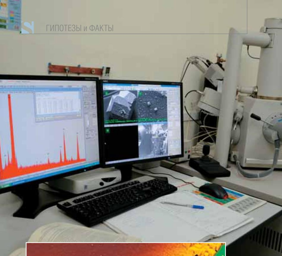
Сканирующий электронный микроскоп *Quanta 200* с приставкой для рентгеновского микроанализа EDAX производства *FEI Company* (США)
